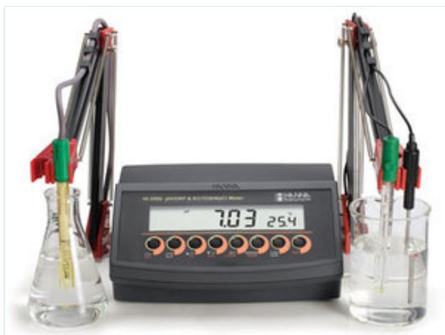
**HI 2550** стационарный pH-метр/ОВП-метр/иономер/кондуктометр/термометр (pH/ORP/ISE/EC/TDS/NaCl/T)
