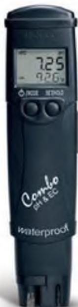
**HI 98130 COMBO** карманный многопараметровый прибор для определения 4-х показателей: рН, ЕС, TDS (кондуктометр), температуры.
