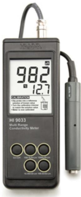
**Предназначен** для работы в полевых условиях. Этот прибор выполнен в водонепроницаемом корпусе, надежно защищающем его от воздействия влаги, дождя, снега, кислотных осадков и т. д. Прибор укомплектован датчиком проводимости HI 76302, специальная конструкция которого обеспечивает точность и независимость показаний от присутствия загрязнений, нефтепродуктов и т. д., а также легкость очистки.
