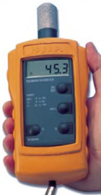
**HI 93640** ручной гигрометр с встроенным сенсором со специальным чехлом для защиты от пыли и внешних воздействий окружающей среды. Идеально подходит для работы в полевых условиях.
