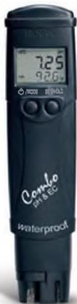
**HI 98129 COMBO** карманный многопараметровый прибор для определения 4-х показателей: рН, ЕС (проводимость), TDS (кондуктометр), температуры в воде и растворах.
