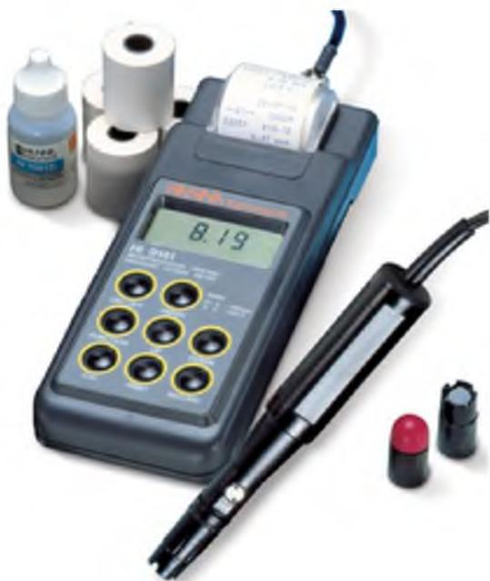
**Предназначен** для мониторинга и записи уровней растворенного кислорода в водоочистных сооружениях и рыбозаводных хозяйствах. В принтере используется обычная нетермическая бумага. Прибор может также работать от источника постоянного тока напряжением 12 В или от адаптера. Микропроцессор обеспечивает автоматическую калибровку, термокомпенсацию давления и солености.
