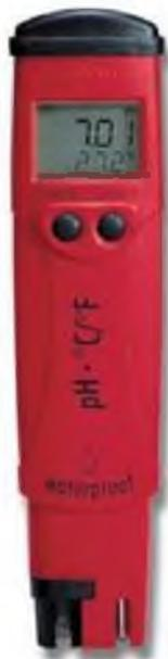
**HI 98128** рНер 5 карманный рН-метр, встроенный электрод, двухуровневый ЖК экран, отображающий рН и температуру, водонепроницаемый корпус, индикатор уровня зарядки батарей. Температурный щуп из нержавеющей стали.
