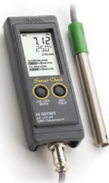
**HI 991003N** портативный микропроцессорный рН-метр/термометр/ОВП общего назначения, режим mV (825 mV).
