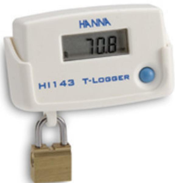
Автономный регистратор температуры во влагонепроницаемом корпусе, до 4000 записей с интервалом 1 мин - 24 часа, в комплекте с USB-адаптером и ПО
