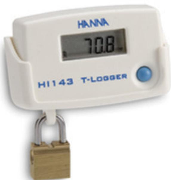
Автономный регистратор температуры с внутренним датчиком NTC во влагонепроницаемом корпусе. До 4000 записей с интервалом 1 мин - 24 часа, в комплекте с RS232-адаптером и ПО. Выбор единиц измерения: ° С или ° F. Min / Max измеренные значения сохраняются и отображаются. Индикатор уровня заряда батареи расположен на дисплее. Доступ к хранящимся данным защищен паролем. Программируемые высокие и низкие температуры.
